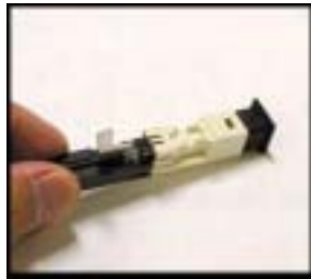
ファイバ挿入ガイドを取り付ける
